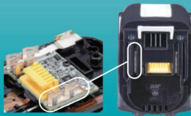
Los terminales de contacto múltiple reducen la resistencia eléctrica y aumentan la estabilidad de la conexión contra la vibración y en última instancia garantizan un suministro de corriente estable a la herramienta
